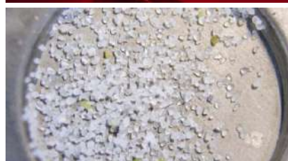
Extração de grãos de quartzo, no laboratório de Datação por Luminescência, sob luz vermelha. Grãos de quartzo, com dimensões entre 160 e 250 µm, extraídos da matriz de um sedimento e preparados para a datação por luminescência do contexto arqueológico de onde foram recolhidos. Preparação de amostras para os protocolos de dosimetria por luminescência e posterior datação.
