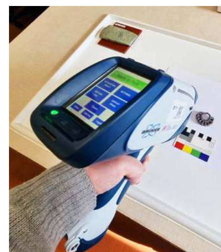
Espectrómetro portátil de XRF para análise elementar in-situ de materiais do Património Cultural.
