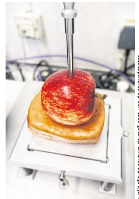
avaliação da textura da maçã com uso de texturómetro.
